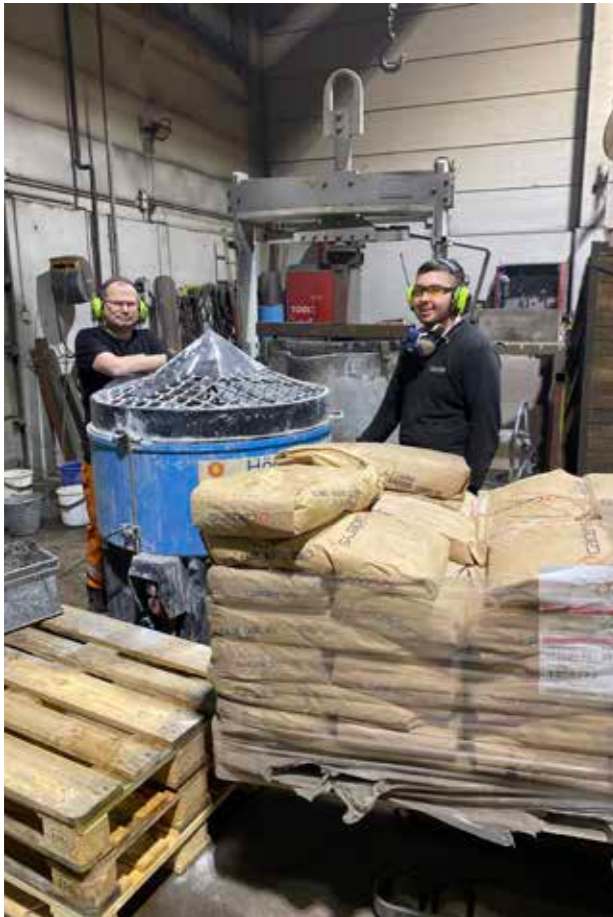
15. februar 2024 @denis cechajic: Støping av foringen på øsa 🍷 Lærningen er selvfølgelig med 😊
